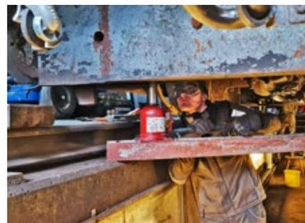
Der Ausbau des Bremsgestänges unter der Lok war notwendig
